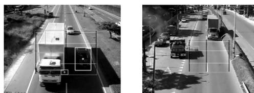
Figura 10. Ejemplos de Falsos Positivos. (a) Vehículo contados 2 veces. (b) Vehículo detectado sin estar en el ROI
